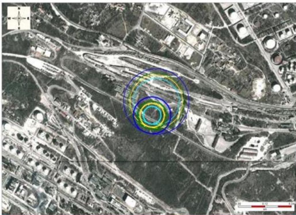
Slika 20. Prikaz udaljenosti utjecaja u slučaju pojave ranog požara lokve
