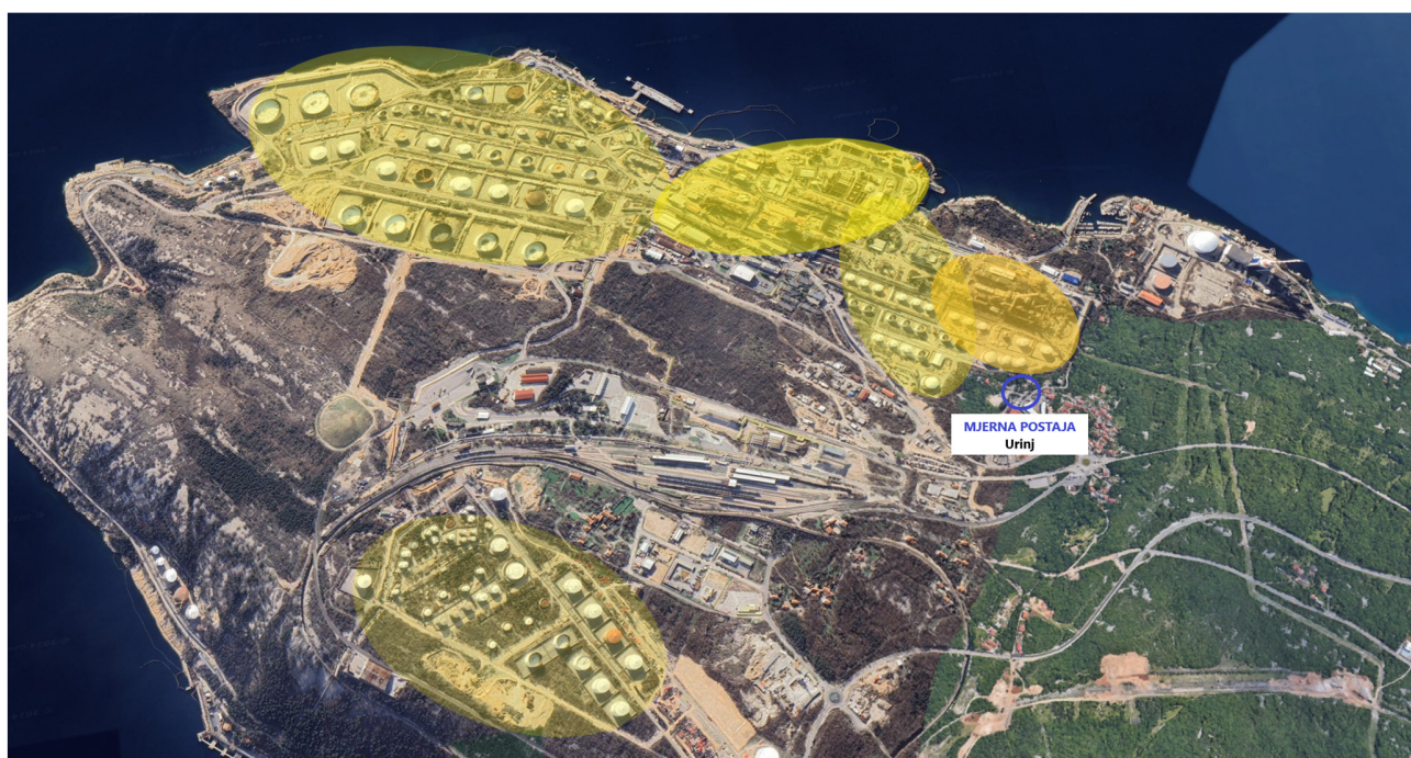
Slika 5.2-1. Moguće lokacije fugitivnih izvora emisija sumporovodika u INA RNR u odnosu na mjernu postaju Urinj (Google Earth; prema podacima iz Upute o praćenju kvalitete zraka i postupanju u slučajevima povišenih koncentracija SO 2 i H 2 S parametara u RNR )
