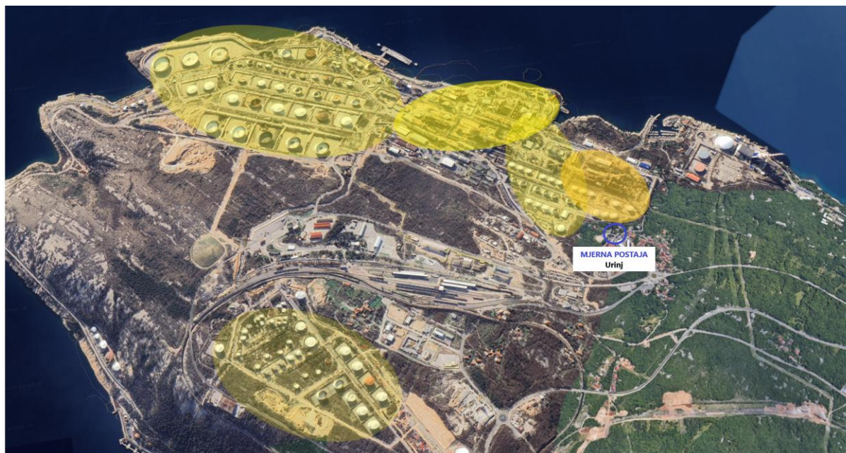
Slika 5.2-1. Moguće lokacije fugitivnih izvora emisija sumporovodika u INA RNR u odnosu na mjernu postaju Urinj (Google Earth; prema podacima iz Upute o praćenju kvalitete zraka i postupanju u slučajevima povišenih koncentracija SO 2 i H 2 S parametara u RNR )
